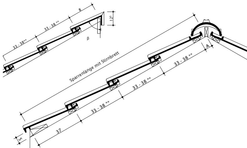
\*\* Bei Decklängen von 33.0 – 35.0 cm müssen die Ortgänge ausgeklingt werden
