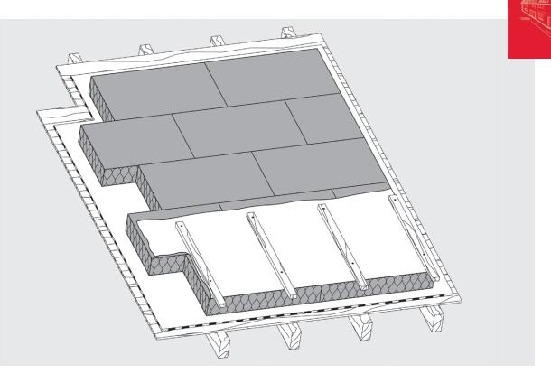
Hoch verdichtete Steinwolle-Dämmplatte mit extra harter Oberlage für die Aufsparrendämmung.
